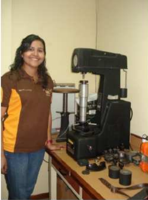
Ensayo de dureza Rockwell B y C (equipo Wilson)
